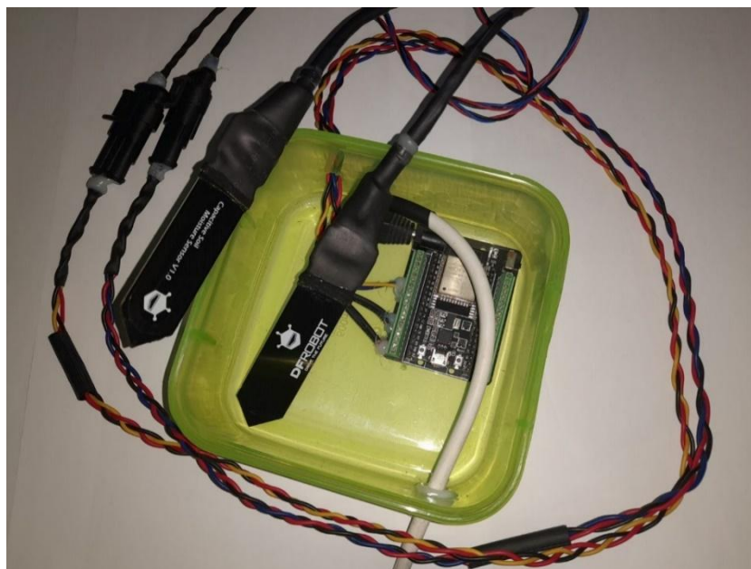
Gambar 4. Instrumentasi Perangkat Transmitter
